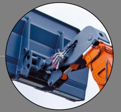
Гидравлическая линия на стреле для подключения навесного оборудования с быстросъемными муфтами
