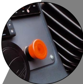
Кнопка аварийной остановки двигателя
