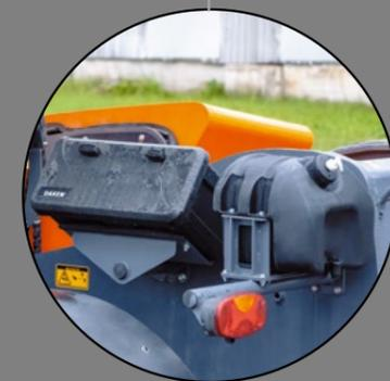
Ящик для инструментов и хранения ЗИП, запираемый на ключ
