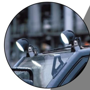
Светодиодное рабочее освещение спереди и сзади: переднее - две фары на кабине, две фары на стреле; заднее - две фары сзади кабины, фонарь заднего хода
